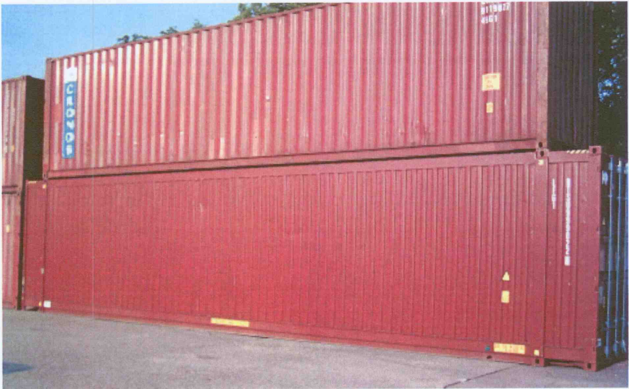
Abbildung: 45-Fuß-Wechselbehälter mit 3 m Innenhöhe, obenauf 40-Fuß-Container (Bild Platz SGKV)
